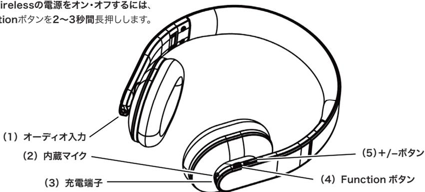
1. **オーディオ入力**：HF Wireless をワイヤレスではなく有線でお使いいただく場合は、付属の 1/8" (3.5mm) オーディオケーブルを使用して、お手持ちのスマートフォンやコンピュータ、携帯音楽プレーヤのヘッドフォン端子と接続します。
